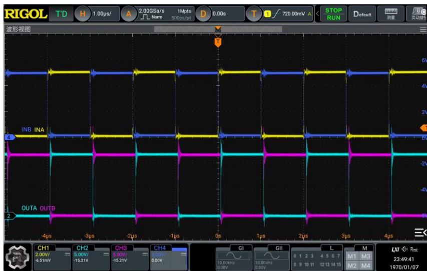
图 2-1 INA/INB 未虚焊时正常波形
