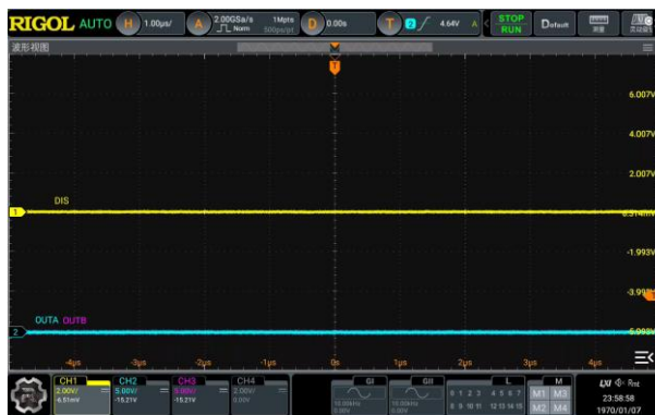
图 2-5 DIS 虚焊时波形 (INA=INB=0-5V PWM)
