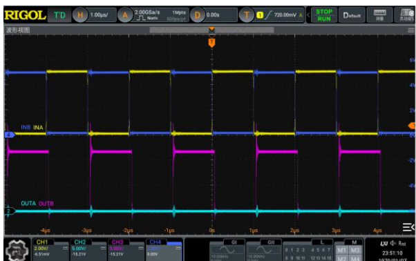
图 2-2 INA 虚焊时波形
