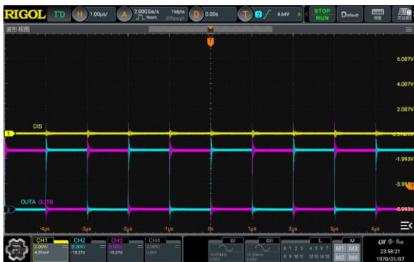
图 2-4 DIS 未虚焊时波形 (INA=INB=0-5V PWM)
