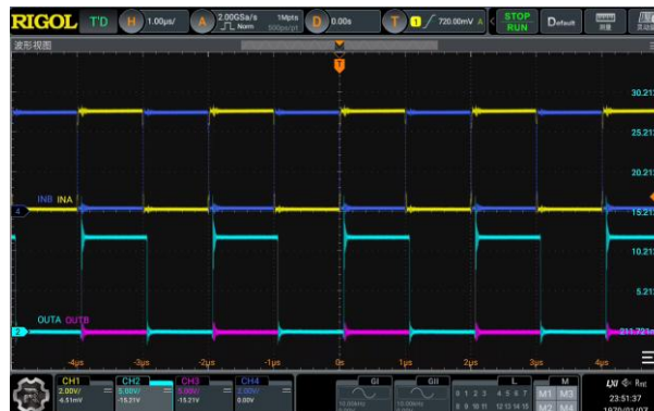
图 2-3 INB 虚焊时波形
