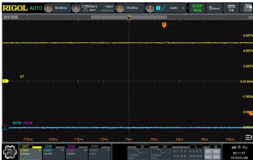
图 2-8 DT 引脚虚焊时异常波形，INA=INB=PWM
