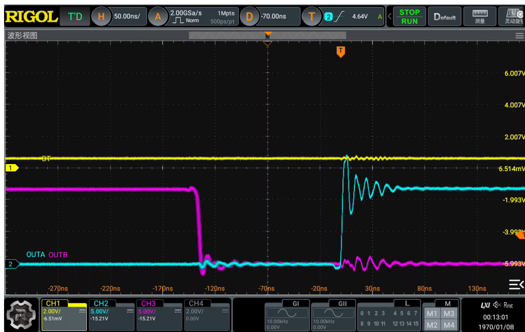
图 2-8 DT 接 R 到 GND 时正常波形，INA=/INB=PWM，有死区时间
